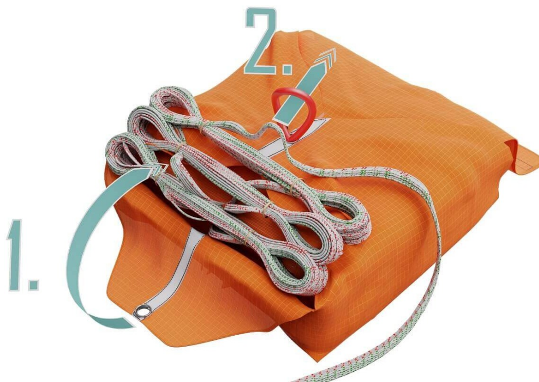
Obr. 45 Svazek lan v kontejneru, připravený pro poslední kontejnerový list.
