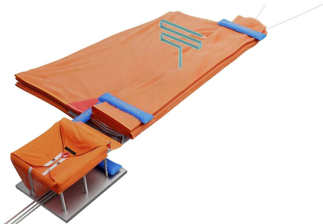
Obr. 36 S-úder s dolní polovinou nahoře.
